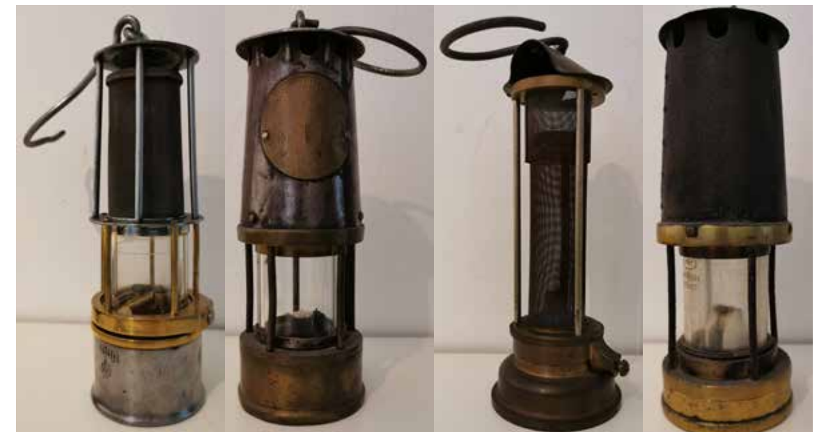
Abbildung 48 Einige der von den Bergleuten benutzten Lampen: v.l.n.r. Wolf'sche Benzinlampe, Boty-Öllampe, Davy-Sicherheitslampe und Clanny-Sicherheitslampe (Fotos und Sammlung Horst Bittner).
